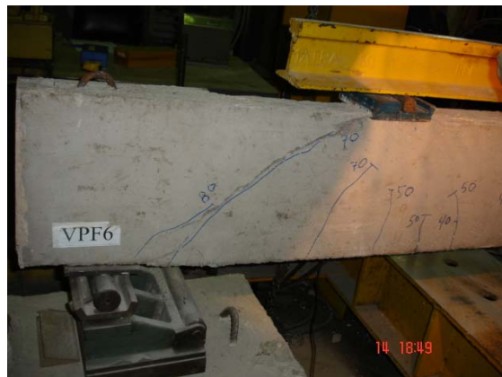
Figura 4.39 – Padrão de fissuração da viga VPF6 (ruína por cisalhamento)
