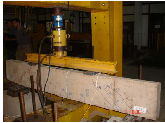
Figura 4.32 – Padrão de fissuração da viga VM2 (ruína por cisalhamento)
