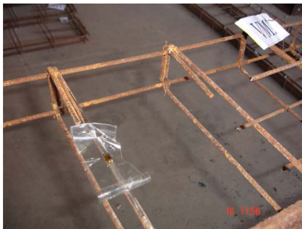
Figura 3.25 – Posição dos extensômetro nos estribos
