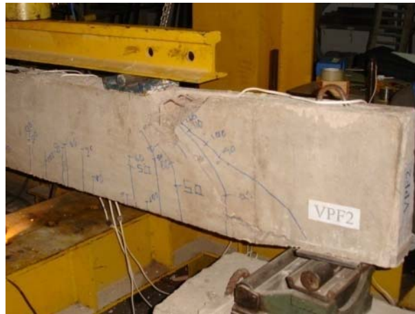
Figura 4.48 – Viga VPF2 após a ruptura
