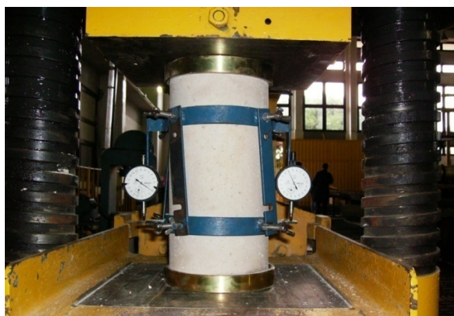
Figura 4.3 – Ensaio de módulo de elasticidade do concreto
