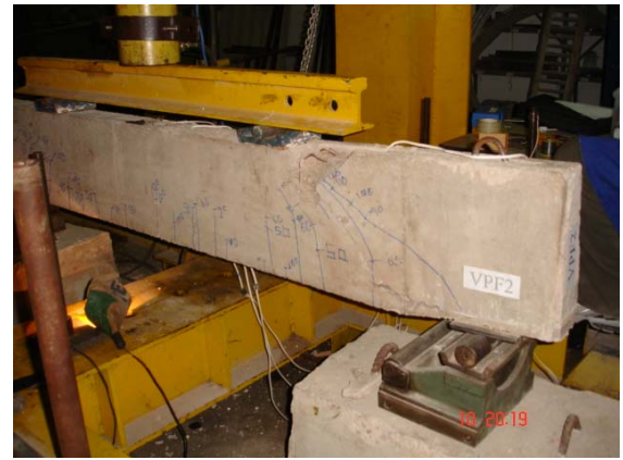
Figura 4.35 – Padrão de fissuração da viga VPF2 (ruína por flexão)
