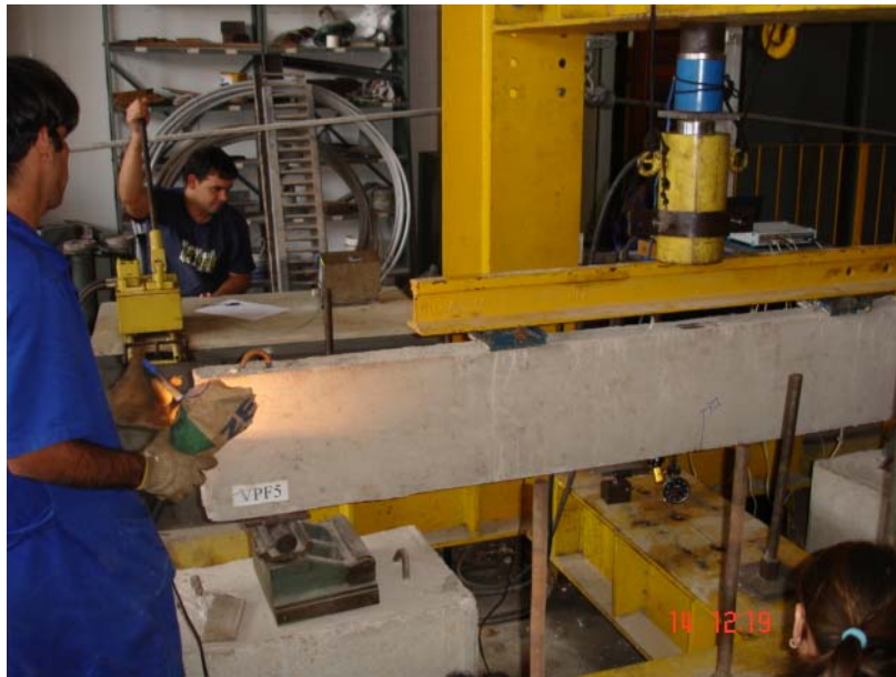
Figura 3.41 - Detalhe do sistema de ensaio e aplicação de carga
