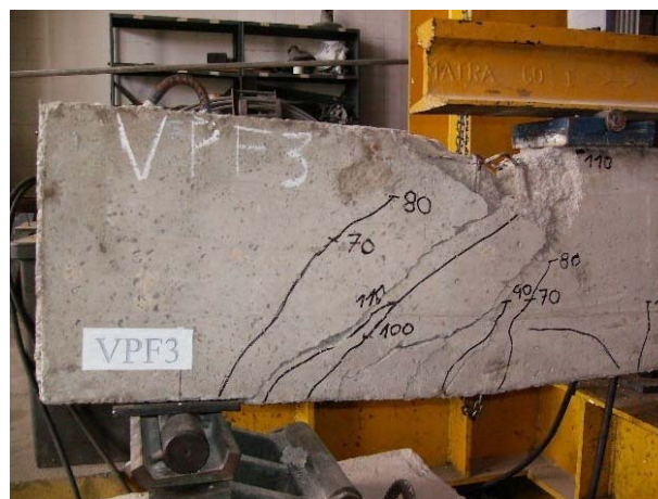
Figura 4.49 – Viga VPF3 após a ruptura
