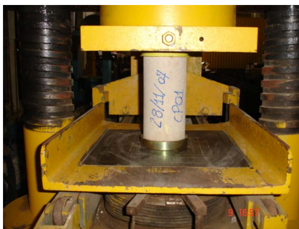
Figura 4.1 – Ensaio de compressão do concreto
