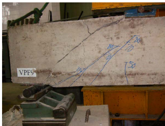
Figura 4.42 – Padrão de fissuração da viga VPF9 (ruína por cisalhamento)
