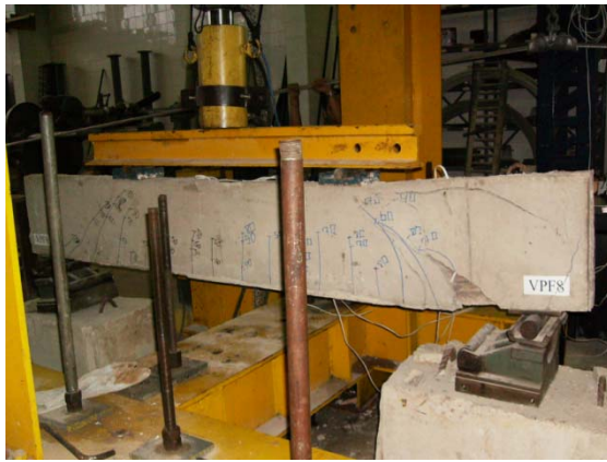
Figura 4.41 – Padrão de fissuração da viga VPF8 (ruína por cisalhamento)
