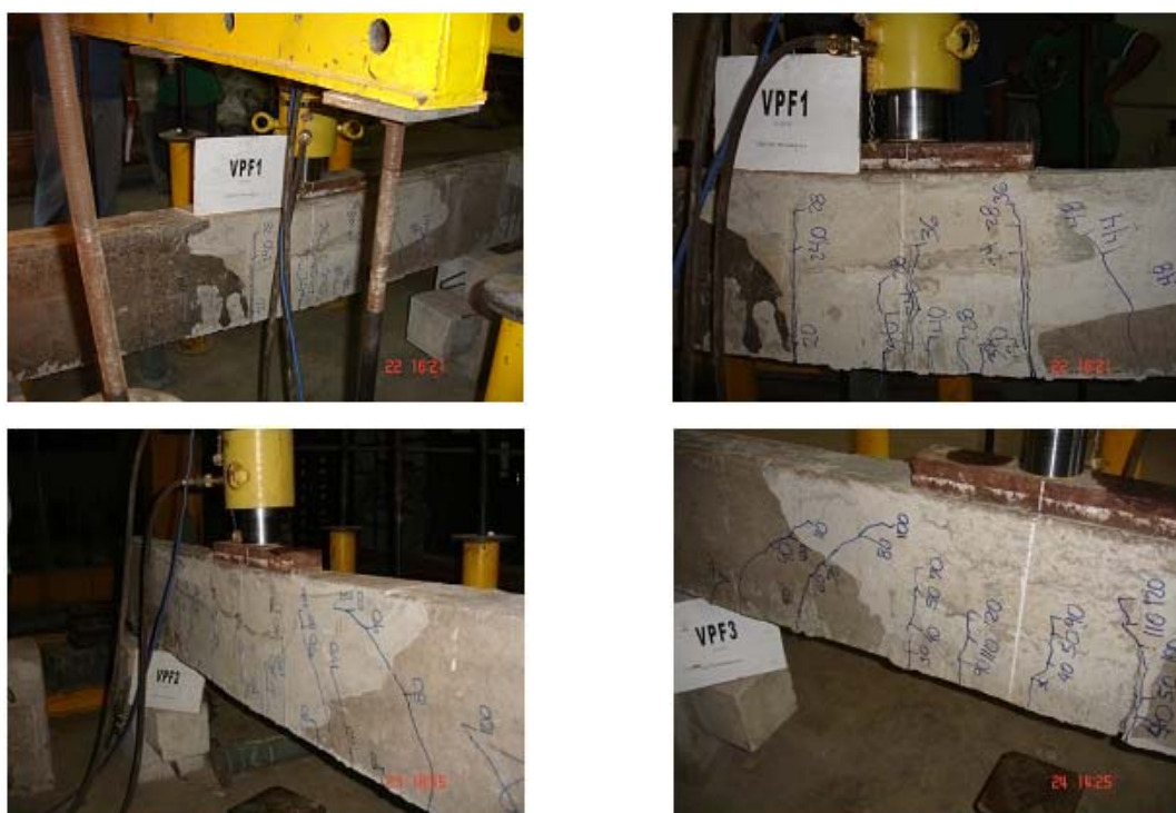
Figura 2.57 - Vigas pré-formadas após os ensaios (SOUZA et al., 2006)
