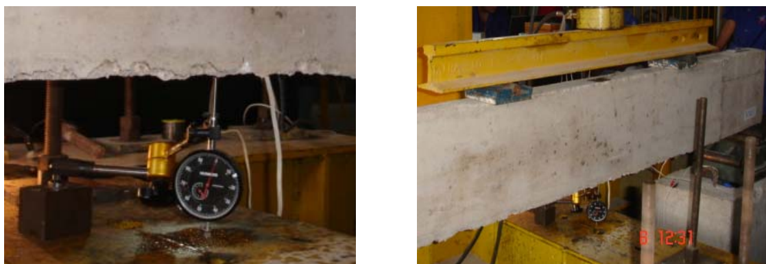
Figura 3.17 – Posicionamento dos deflectômetros
