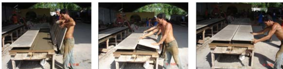
Figura 2.5 - Fabricação de elementos pré-formados
